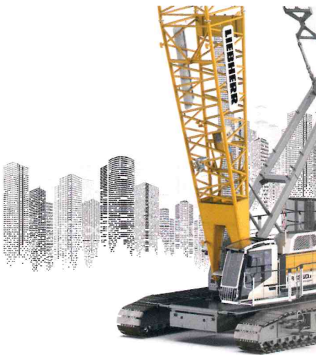
Der LR 1200.1 unplugged mit 200 t Traglast und der 250 t starke LR 1250.1 unplugged sind die ersten batteriebetriebenen Raupen Krane der Welt.
