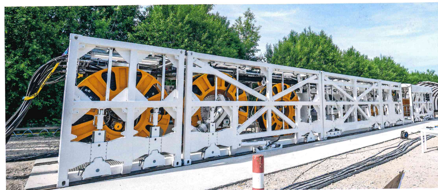
Das minimal-invasive Bauer Cube System wurde exakt in Container-Abmessungen entwickelt. Es reduziert die Auswirkungen von Fräsbaustellen an der Oberfläche auf ein Minimum.
